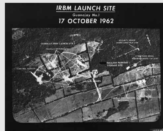
キューバ危機時にソ連がキューバに建設した弾道ミサイル基地（GRANGER／時事通信フォト）
