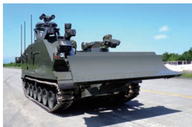
CBRN 対応遠隔操縦車両システム (写真：防衛省)
