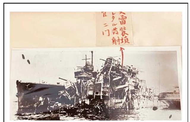
防衛研究所蔵「駆逐艦（榊）被害状況写真」
