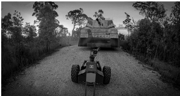
図 17：Raider Targetry 社の無人地上車両と細密な目標を組み合わせた可搬型移動目標システム (Mobile Moving Target System)
