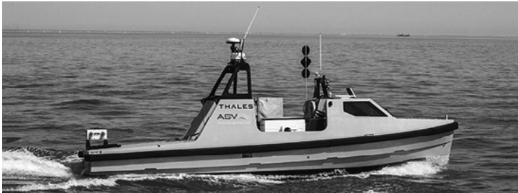
図 12 : デコイ実験で使用された Thales 社 Halcyon USV
