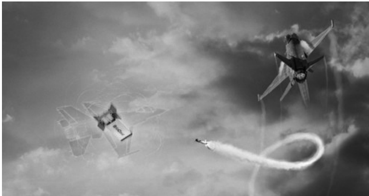
図 14：防御対象の航空機を模す BriteCloud デコイ
