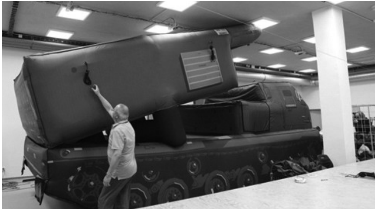
図 15：高機動ロケット砲システム (HiMARS) 膨張式デコイ 55
