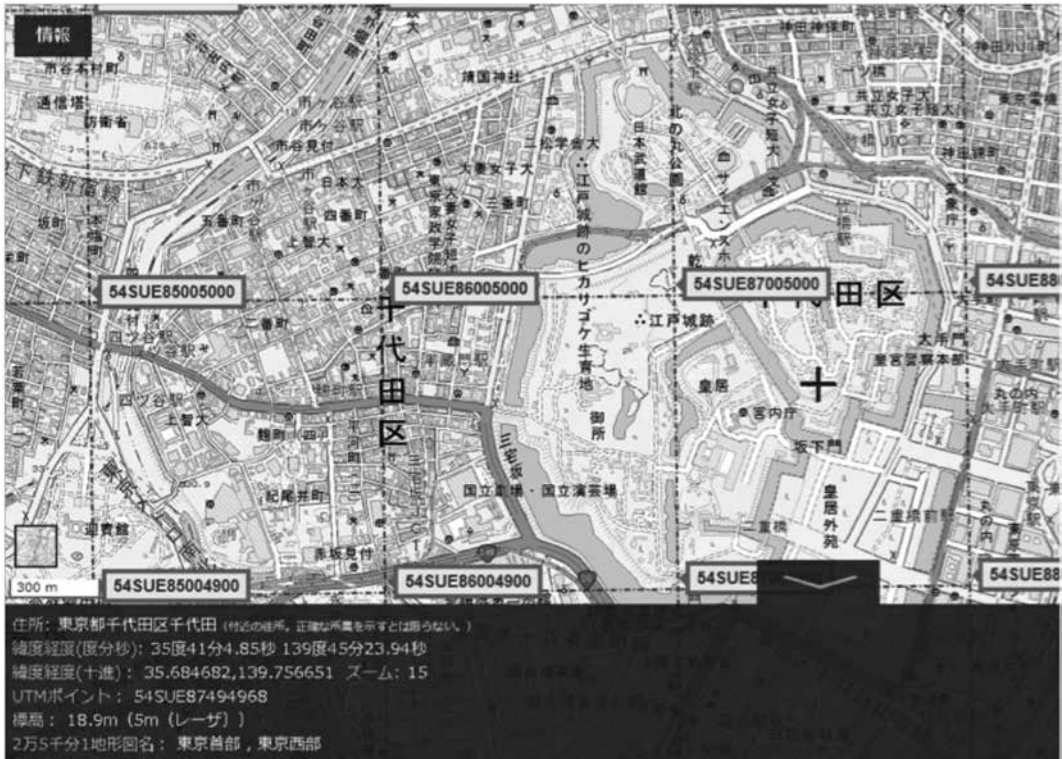
図3 PC (タブレット) 画面上の地理院地図 住所、緯度経度、UTM 座標が同時に表示される。
